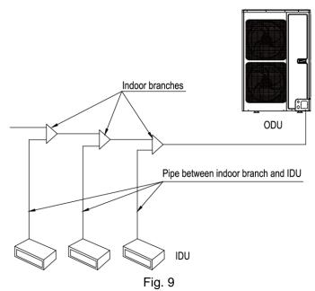
Rated capacity of IDU Gas pipe Liquid pipe C(Btu/h) (mm/inch) (mm/inch) Φ9.52 Ф6.35 C≤9600  $(\Phi 3/8)$  $(\Phi 1/4)$ Ф12.7 Ф6.35 9600<C≤17000  $(\Phi 1/2)$  $(\Phi 1/4)$ Ф15.9 Ф9.52 17000<C≤48000  $(\Phi 5/8)$ (Ф3/8) Ф19.05 Φ9.52 48000<C≤55000  $(\Phi 3/4)$  $(\Phi 3/8)$ Ф22.2 Ф9.52 55000<C≤96000 (Φ7/8) (Ф3/8)
